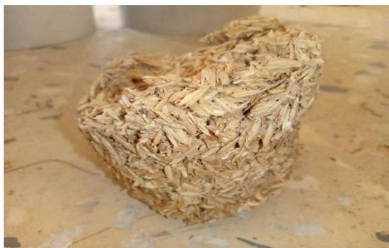
**Figure 3 (a):** Sawdust briquettes
